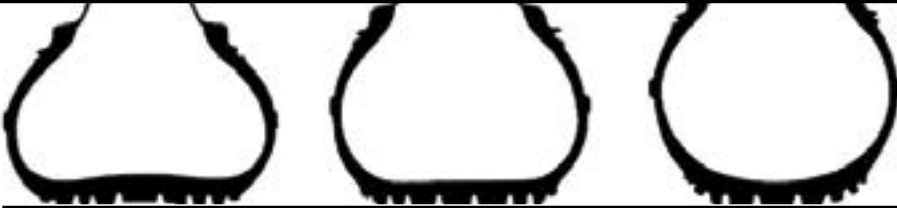
Mynd sýnir veggrip miðað við of lágan, réttann og of mikinn loftþrýsting
