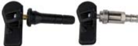
TPMS skynjari er festur á ventil og eru þeir bæði til sem gúmmi og málmventlar sem eru skrúfaðir fastir
